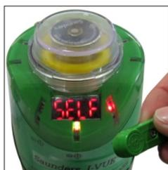
Com o monitor em modo de operação, aproxime o chaveiro magnético com o pólo Norte "N" da chave magnética N3 por 3 segundos para iniciar o auto setup. O monitor irá acionar e desacionar a válvula solenóide (3, 5 ou 10 vezes) de acordo com a quantidade de ciclos configurada no menu (Self Calibration Setting). No auto setup o monitor aprende a posição e o tempo de abertura e fechamento da válvula. Depois de concluída o auto setup, o monitor volta ao modo de operação normal.
