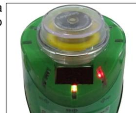
**SELF** **Auto Setup:** A configuração do auto setup permite que o usuário configure o monitor para aprender a posição e o tempo de abertura e fechamento da válvula em 3, 5 ou 10 ciclos. Quanto maior o número de ciclos, maior será a precisão na detecção da posição. Para realizar o auto setup, basta aproximar o chaveiro magnético com o pólo norte "N" da chave magnética N3 por 3 segundos, quando o monitor estiver em modo de operação. O monitor irá exibir a mensagem "Self Calibration".
