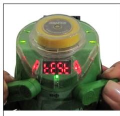
Para esta opção, serão necessários 2 chaveiros magnéticos. Segure as duas chaves magnéticas com o pólo norte "N" sobre as chaves N1 e N3, ao mesmo tempo por 3 segundos. O modo de demonstração faz com que o monitor abra e feche a válvula com ciclos ininterruptos. O display mostra "Deno Test". Para sair do modo de demonstração, segure novamente os dois chaveiros magnéticos sobre as chaves N1 e N3.
