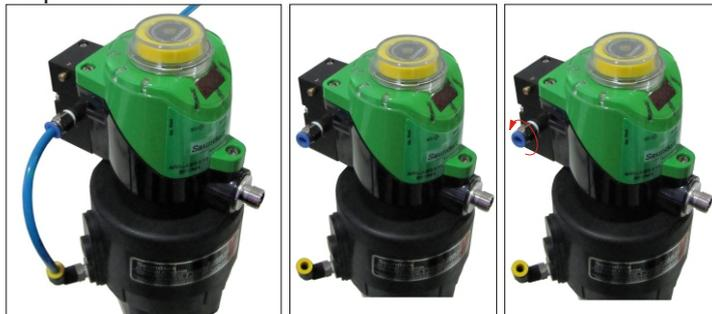
3º - Afrouxe os três parafusos que prendem o módulo monitor na caixa de conexões.
