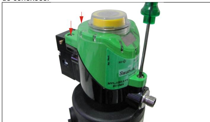
7° - Coloque os engates rápidos nos orifícios pneumáticos da válvula e do atuador.
