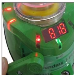
Com o monitor em modo de operação, aproxime o chaveiro magnético com o pólo Norte "N" da chave magnética N1 por 3 segundos. O display mostrará "Sol Forced" e o led verde irá acender. Para desenergizar a solenóide, aproxime novamente o chaveiro magnético da chave N1 por 3 segundos.
