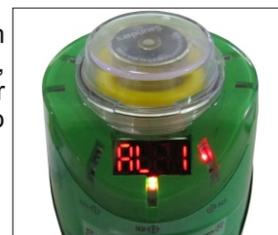
**DAY** **Alarme de Dia:** É possível gerar um alarme para os dias em que o monitor está em operação (AL 2). Este alarme é muito útil na realização de manutenção preventiva. O usuário pode, por exemplo, configurar o monitor para que gere o alarme 30 dias após a instalação e início na operação do monitor. Nesta opção também é possível zerar os dias de operação do monitor (CLR), afim de configurar um novo alarme de dias.
