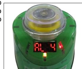
**PARt** **Contador Parcial:** Através desta opção é possível configurar o monitor para que gere um alarme quando o contador parcial chegar a um determinado número de ciclos (AL 1), avisando o operador que está na hora de fazer a manutenção preventiva. É possível ativar o alarme (A\_ON), cancelar o alarme (C\_AL) e desabilitar o alarme (A\_OF). Na opção C\_AL o monitor desabilita o alarme e cancela a contagem dos ciclos.
