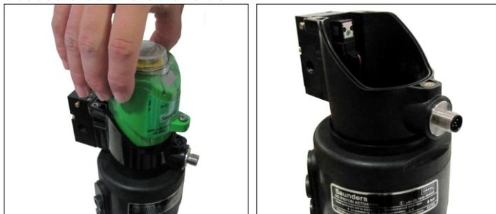
5º - Remova o acionador e com a ajuda de uma chave adequada, desconecte os fios da bobina dos terminais elétricos.
