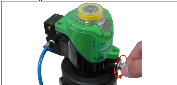
2º - Remova as conexões pneumáticas e engates rápidos do corpo da válvula.
