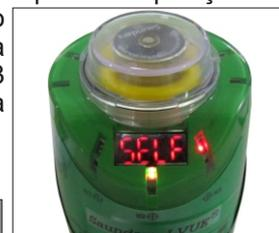
**HAnd** **Calibração Manual:** O usuário pode definir manualmente a posição aberta e fechada da válvula, para isso é necessário movimentar a válvula e confirmar sua posição aproximando o chaveiro magnético com o pólo Sul "S" da chave magnética S2.
